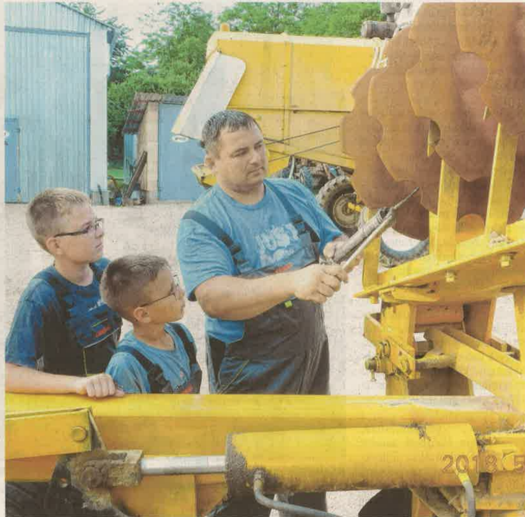
Szummer László egy IH 10-770 nehéz tárcsa karbantartását, a zsírpontok elhelyezkedését mutatja fiainak, Attilának és Lacinak. Megoldják házon belül?
