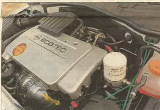
A CNG-s átalakításra egyedül a fehér gázreduktor utal
